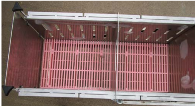
Intercalaire glissé dans des fentes répartie sur la longueur de la caisse (Odylus)
