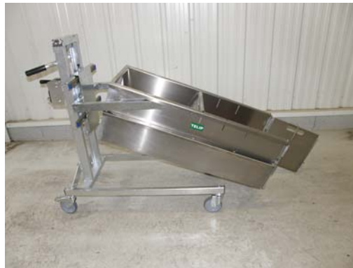
En reculant les fourches et en les levant, la caisse peut être inclinée
