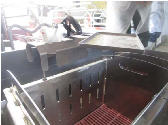
Porte outils et plateau pivotants (Odylus)
