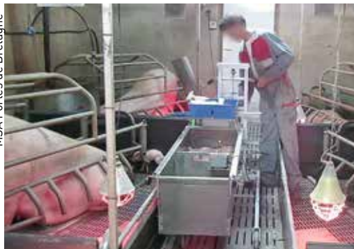
> Un treuil manuel permet de régler la caisse en hauteur (60 cm de course).
