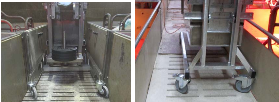
Les roues du chariot doivent pivoter dans le couloir
