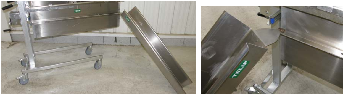
Toboggan pivotant accroché sur les cornières de la caisse (Télip)
