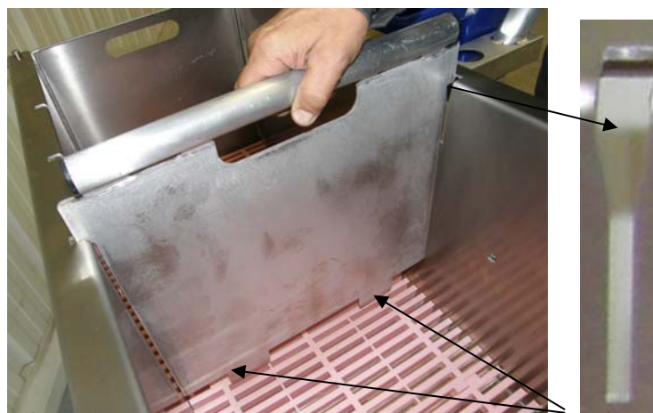
Cloison glissée dans des fentes en Y de la caisse. Pattes de blocage (Télip)
