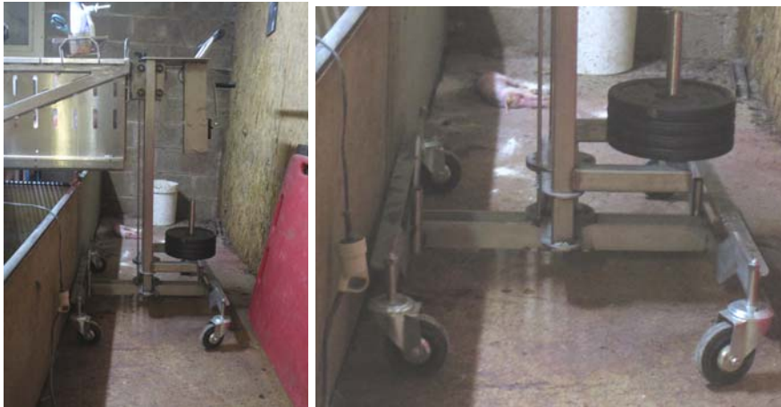
Le contrepoids posé sur la partie pivotante est toujours à l'opposé de la caisse
