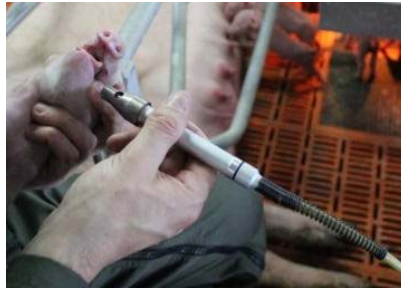
Meuleuse électrique sur batterie avec prolongateur entre le moteur et la meule (légèreté et meilleure prise en main)
